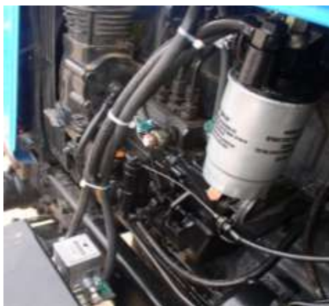
Рисунок 2 – Расходомер DFM, установленный на тракторе: а – общий вид установки прибора; б – счетчик-расходомер
