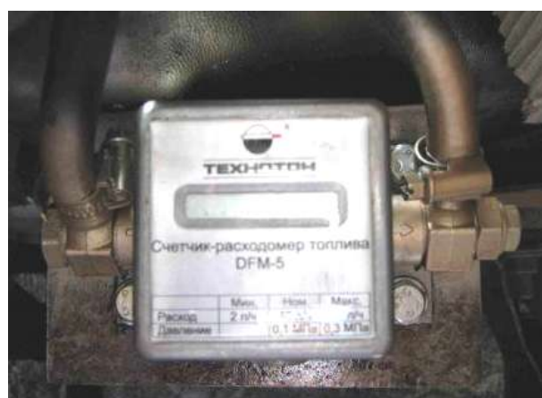
Рисунок 2 – Расходомер DFM, установленный на тракторе: а – общий вид установки прибора; б – счетчик-расходомер
